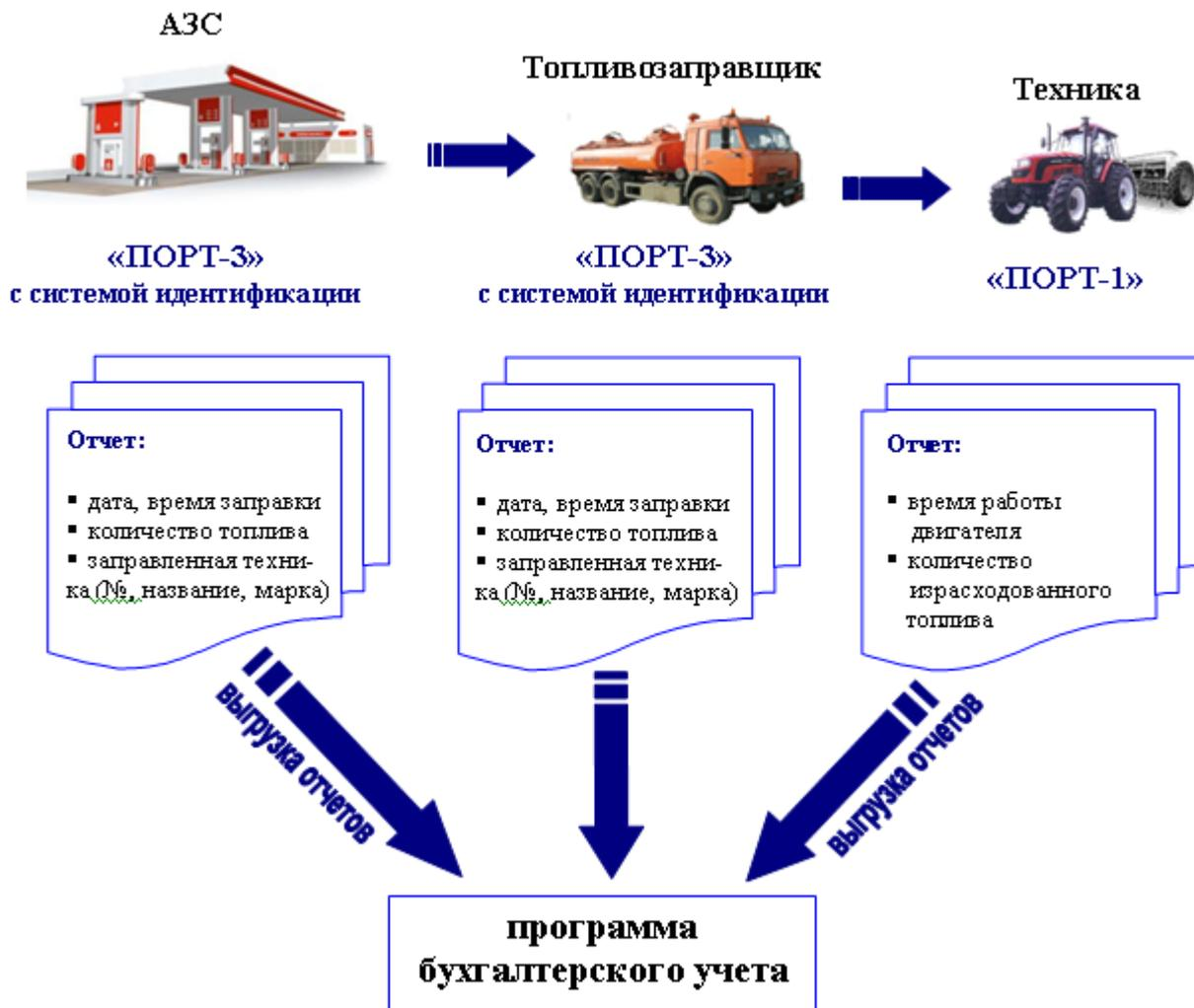
Предлагаемая система автоматизации, позволяет обеспечить **тотальный контроль и учет за движением и расходом топлива** на предприятиях в различных отраслях народного хозяйства.
